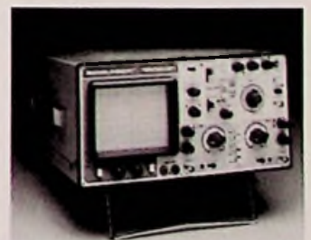
Bild 1: Preiswert und hochwertig – ein neues 20-MHz-Oszilloskop (Beckman-Pressbild)
