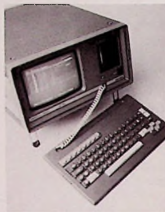
Bild 1: Spezialcomputer zum Testen der Eigenschaften von ISDN-Netzen (Siemens-Pressbild)
